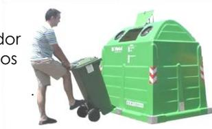
**2º** Una vez colocado frente al contenedor aplicamos presión sobre el pedal de alzado. Por el efecto de "palanca", el contenedor se eleva fácilmente con el mínimo esfuerzo
