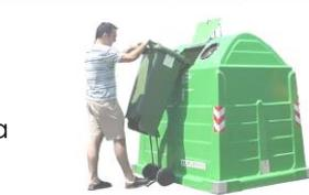
**4º** Aquí se inicia el momento de descarga del "Ale-Hop". Debemos coger de la parte inferior para proceder a voltear. La parte superior actuará como bisagra.
