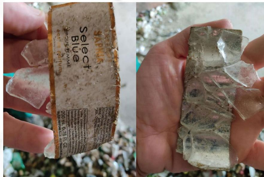
Imagen: trozos de vidrio pegados a la etiqueta original que forman parte del rechazo de la planta de tratamiento y por lo tanto no podrán ser reciclados. Fuente: Ecovidrio.
